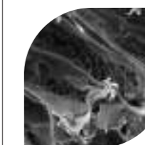
NAUDOTA PAŠLUOSTĖ (Sunaudota skylėtoji struktūra su nusėdusiu purvu)
